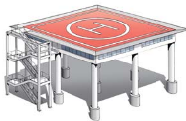
津波対策ヘリポートと備蓄倉庫
