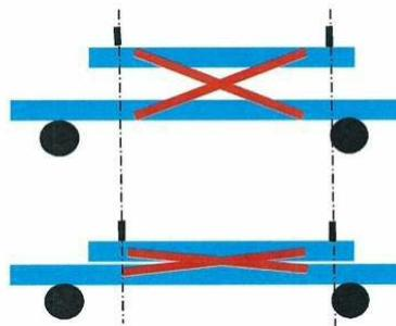
前部2カ所、後部2カ所でクロスチューブを支えて機体を上下する。
